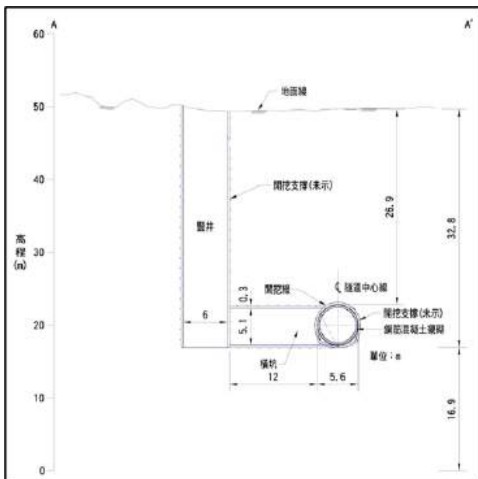
圖 6-27 建議方案豎井及橫坑施工場地示意圖
